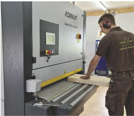
*/ Für sauber geschliffene Oberflächen sorgt eine Breitbandschleifmaschine vom Typ Finish 1352 Modular.*
