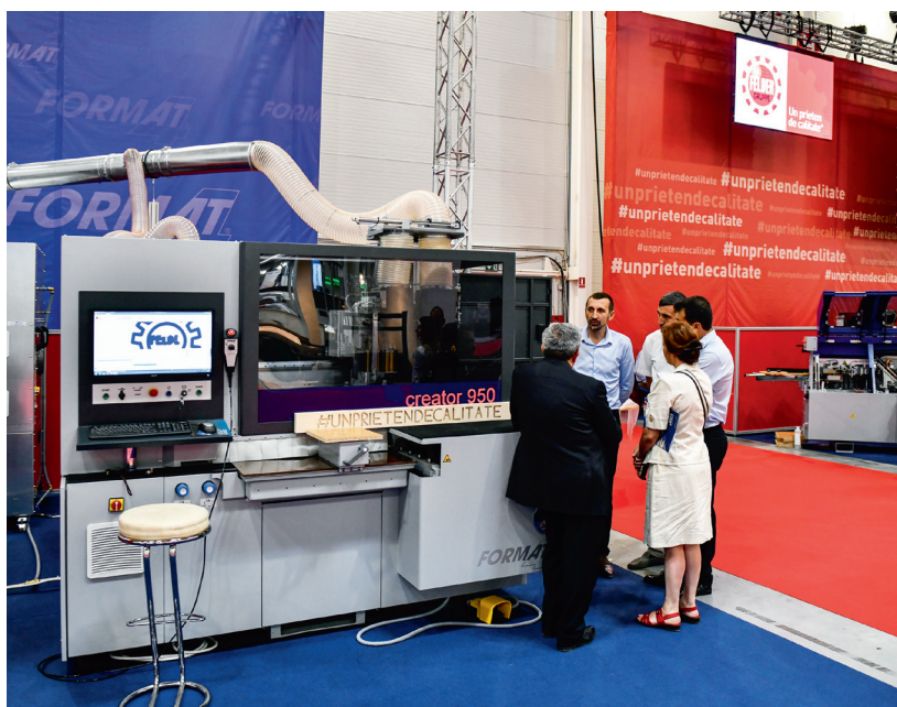
↑ Creator 950, noul centru de prelucrare cu comandă numerică dedicat găuririi și frezării panourilor de la Format-4, prezentat de Felder Gruppe România la BIFE-SIM 2018
