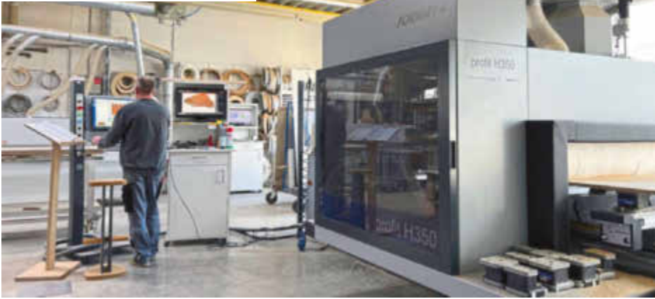
/ Formen- und Bearbeitungsvielfalt sind Programm: Seit 2023 ist in der Tischlerei das 5-Achs-CNC-Bearbeitungszentrum Format4 Profit H350 im Einsatz.
