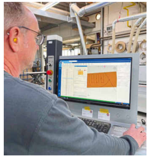
/ Ein letzter Check am Bildschirm der Format4-CNC, bevor das Teil bearbeitet wird.
