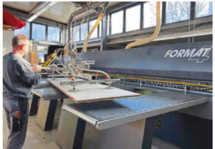
Zuschnitt nach Maß: Plattenaufteilsäge Format4 Kappa Automatic 80 in Kombination mit einem Vakuumheber für ergonomisches Beschicken.
