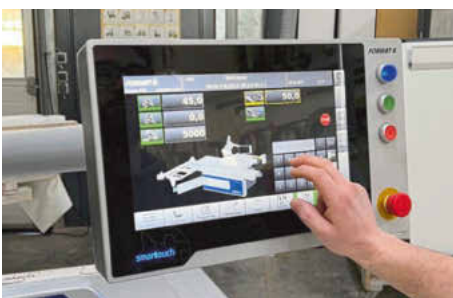
/ Alle Achsen der Formatkreissäge werden von der zentralen Bedieneinheit mit Touchscreen angesteuert.
