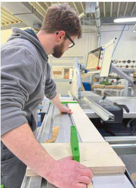
/ Unterstützt gleichermaßen sicheres und präzises Arbeiten: Sägehilfe „Fritz und Franz“.
