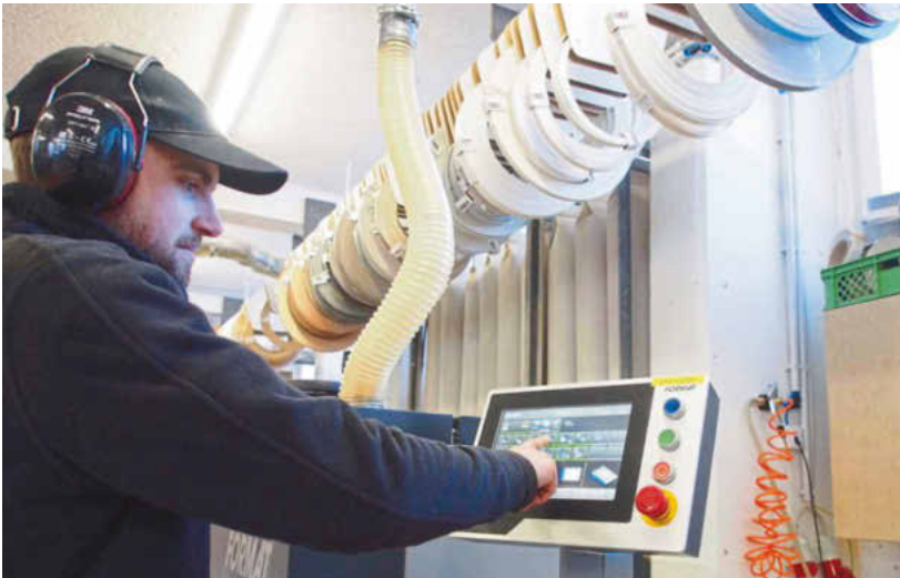
/ Die Smartouch-Steuerungseinheit mit 10"-Touchscreen ermöglicht eine einfache und schnelle Auswahl der Aggregate sowie die komplette Überwachung aller Maschinenfunktionen.
