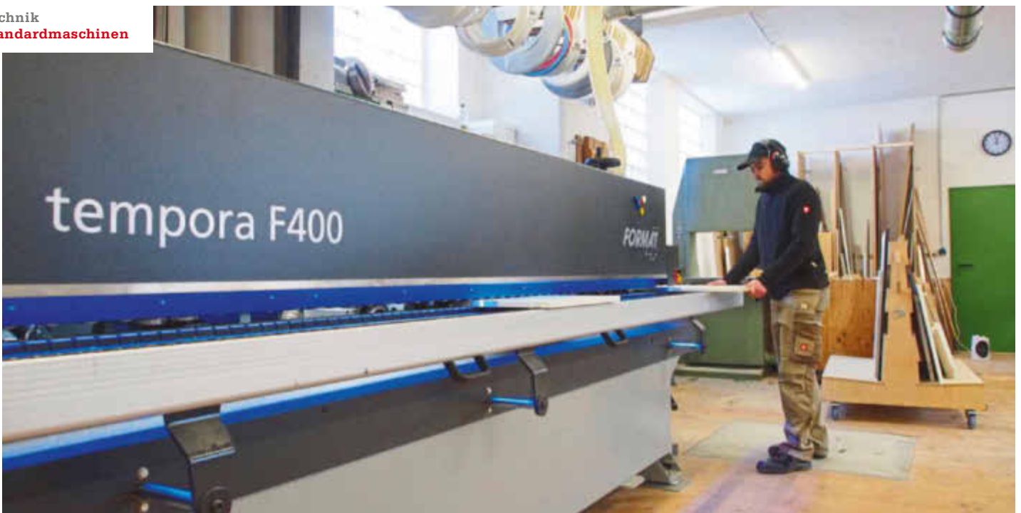
/ Seit Anfang 2021 hat Huith eine Kantenanleimmaschine vom Typ Format4 Tempora 400 45.03 L im Einsatz. Je nach Einsatzgebiet kann darauf Rollenware von 0,4 bis 3,0 mm für Plattenmaterialien bis 45 mm Dicke verarbeitet werden. Die Ausstattung umfasst u. a. Fügefräsen, Eckenkappen, Polieren und Ziehklinge.
