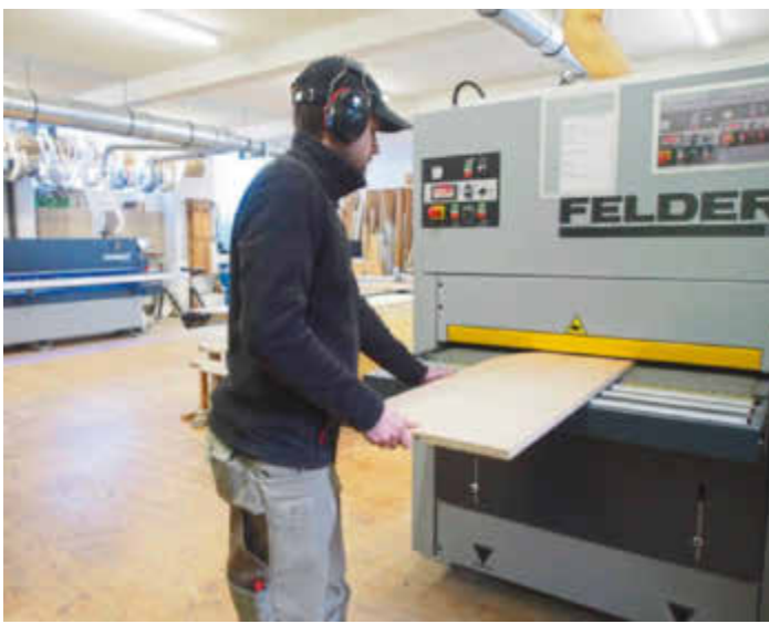
/ Jüngste Investition ist diese Breitbandschleifmaschine vom Typ FW 950 Classic. Sie verfügt über ein Kombiaggregat mit elektronisch-pneumatischem Schleifkissen.
