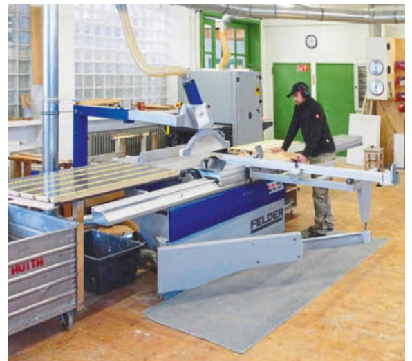
/ Solide, präzise und ohne großen Schnickschnack verrichtet die Formatkreissäge Felder K 975 seit Jahren zuverlässig gute Dienste.
