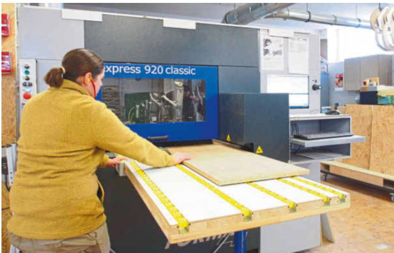
/ Die kompakte Format4-CNC Express 920 Classic erledigt Bohr- und einfache Fräsarbeiten wirtschaftlich und präzise. Programmiert wird sie bei Huith derzeit noch an der Maschine.
