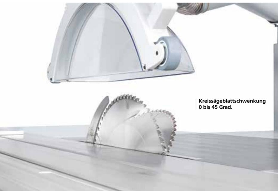
Kreissägeblattschwenkung 0 bis 45 Grad.
