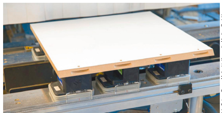
Die CNC hat dieses Werkstück formatiert, auf Gehrung geschnitten sowie mit Clamex-Nuten und -Bohrungen versehen
