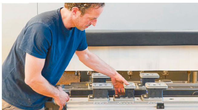
Für jedes Werkstück bringt er die Traversen und Sauger mithilfe eines LED-Leitsystems schnell und sicher an den richtigen Platz
