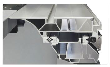
Der Formatschiebetisch ist durch den massiven Profilbau verwindungssteif, außerdem ist er staubgeschützt und wartungsfrei
