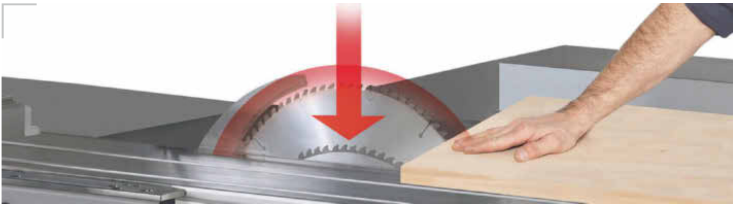
Das PCS (Preventive Contact System) löst nach Unfallgefahrerkennung in wenigen Millisekunden die Versenkung des Sägeblattes aus. Die Sicherheitsabsenkung erfolgt beschädigungsfrei. Auf Knopfdruck ist die Formatkreissäge dann sofort wieder einsatzbereit.
