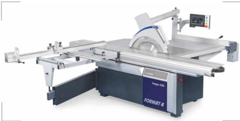
Neuaufgabe eines erfolgreichen Klassikers: Auch die bewährten Formatkreissägen vom Typ Format4 Kappa 450 und Kappa 450 X-Motion können jetzt mit PCS geordert werden.
