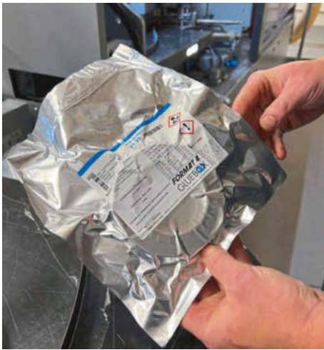
/ Unkompliziert im Handling: Die Kleberollen sind luftdicht verpackt und ungeöffnet ein Jahr haltbar.
