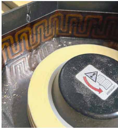
/ Die Kleberollen gibt es mit 25 oder 100 lfm sowie für 16, 19, 28 und 40 mm Werkstückhöhe.
