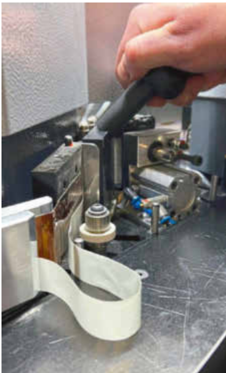
/ Werkzeuglos: Mit wenigen Handgriffen ist der PUR-Klebestreifen „eingefädelt“ und einsatzbereit.
