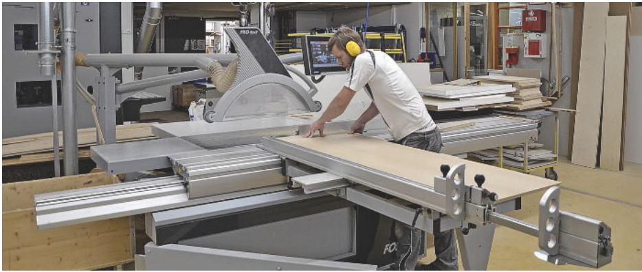
Die Formatkreissäge Kappa 590 steht im Zentrum des Maschinenraums und wird universell eingesetzt. Über die hochmoderne E-Motion-Steuerung werden Maße und Schwenkgrade komfortabel per Tastatur eingestellt.
