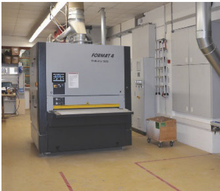
Für hochwertige Oberflächen sorgt die Breitbandschleifmaschine Format4 „Findustry“.
