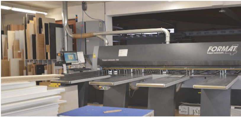
/ Die Plattenaufteilsäge Kappa Automatic 100 bietet höchste Präzision bei einfachster Bedienung. Über das Bedienpult werden die Auftragsdaten überspielt, der Etiketten-Drucker markiert das Bauteil.
