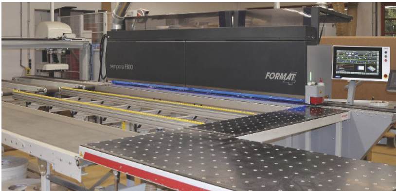
/ Die Kantenleimmaschine Tempora F 800 ist mit einer E-Motion-Steuerung ausgerüstet. Dank automatischer Teilerückführung bietet sie hohe Performance im Einmann-Betrieb.
