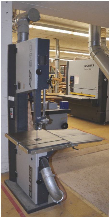
/ Unverzichtbar im Schreineralltag: Die klassische Bandsäge FB 510 von Felder.
