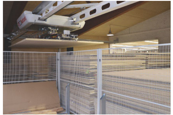
/ Das Plattenlager CSF von Barbaric beschickt die Plattenaufteilsäge automatisch mit dem benötigten Plattenmaterial.
