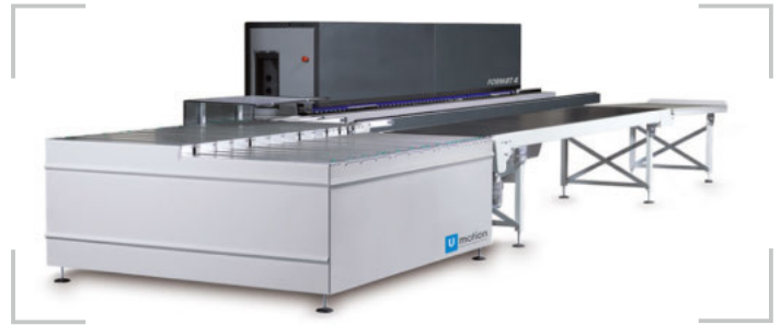
/ Einfach zur Ein-Mann-Bedienung: Fachkräfte sollen sich auf die Anwendung konzentrieren, nicht „Bauteile spazieren tragen“. Abhilfe schafft eine einfache Rückführung.
