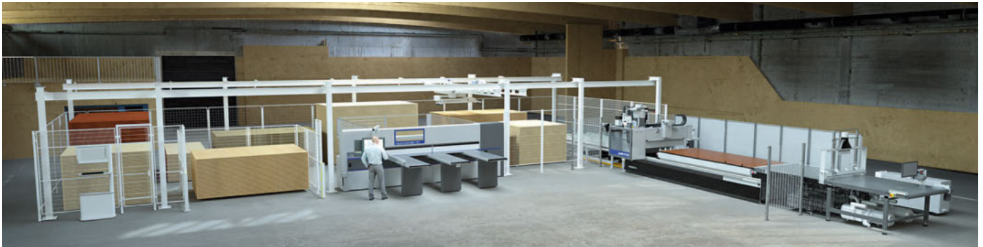
/ Flächenlager: Platten werden chaotisch oder sortenrein gelagert und verwaltet. Der Raum wird optimal ausgenutzt und Platten werden automatisiert der Plattensäge oder der Nesting-CNC Maschine zugeführt. Amortisationszeiten von 1,5 Jahren sind hier möglich.
