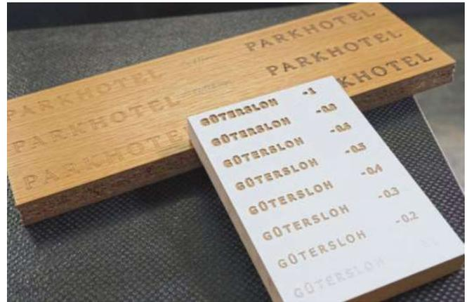
/ Der Großauftrag für das Parkhotel in Gütersloh beinhaltet auch Details wie CNC-gefräste Beschriftungen, für die zunächst die richtige Formatierung getestet wird.
