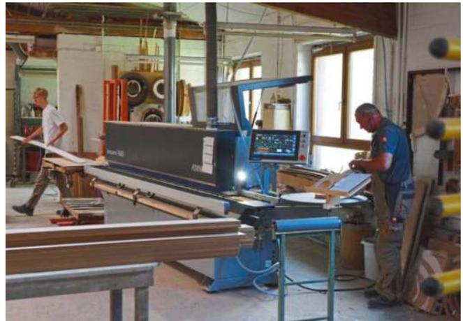
*/ Zusammen mit dem auf vier Achsen aufgerüsteten CNC-Bearbeitungszentrum Profit H200 erwarb Neumann die Kantenanleimmaschine Tempora F600 für das PUR-Kleben.*
