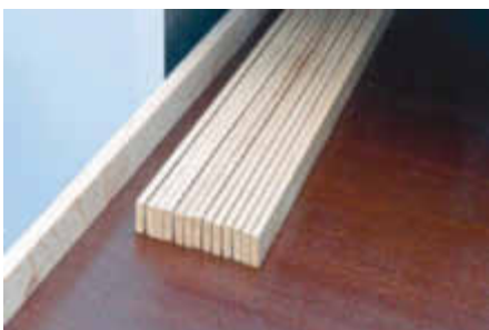
Der Kehlautomat erzeugt präzise Leisten, die eine Spezialmaschine zu Klötzen sägt
