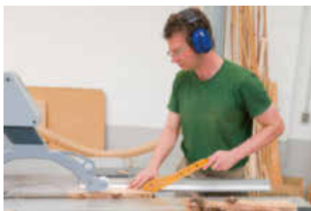
Martin Ehlers hat das Brett besäumt und schneidet es parallel
