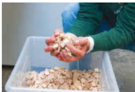
Erst nach Kontrolle der Maßhaltigkeit geraten die Klötze in diese Kiste
