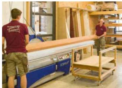
Früher war das die Formatkreissäge des Betriebs. Jetzt dient sie als Längsaufteilsäge
